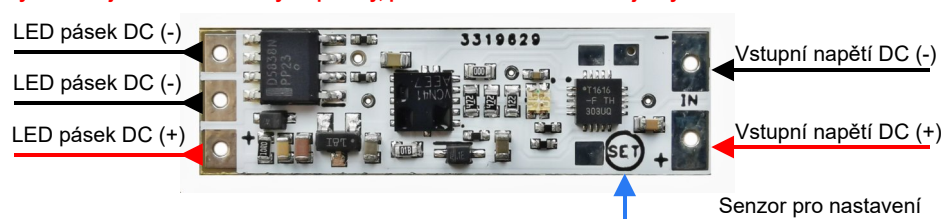
Obr.1 - Zapojení vývodů modulu stmívače
